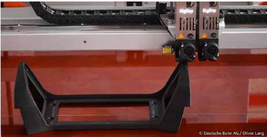
»Mobility goes Additive« Projekt der Deutschen Bahn, 3D-Druck einer Kopfstütze für einen Regionalzug
