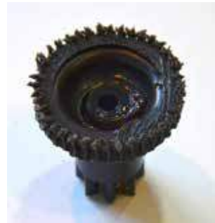
oben abgenutztes Motorzahnrad links 3D-reparierter Motorblock
